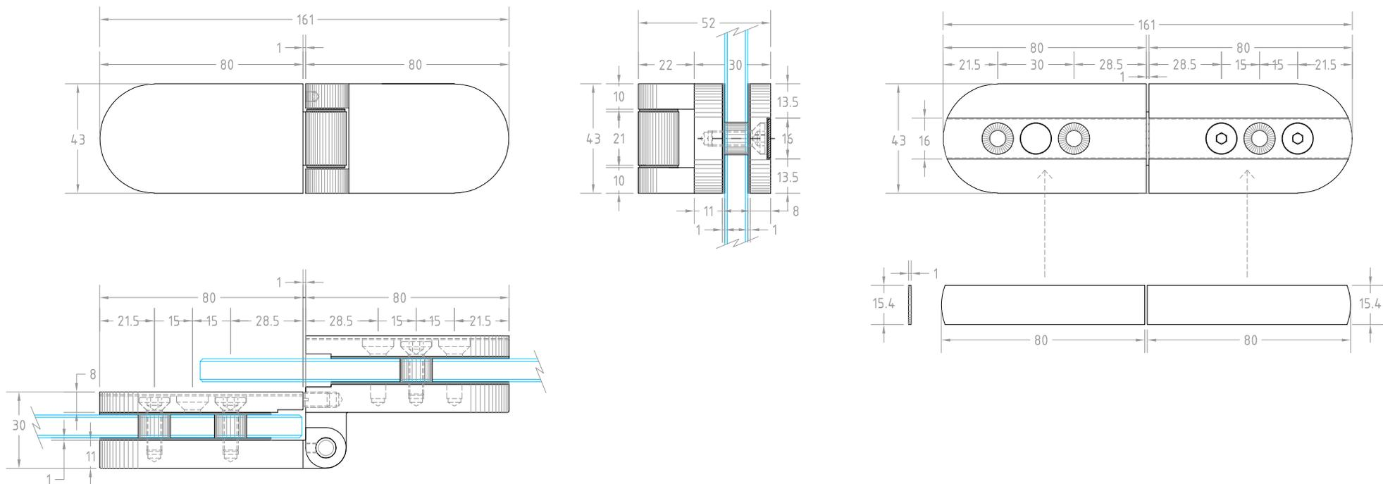
Nota: El traslape de esta bisagra permite un margen de error de hasta 40mm.
